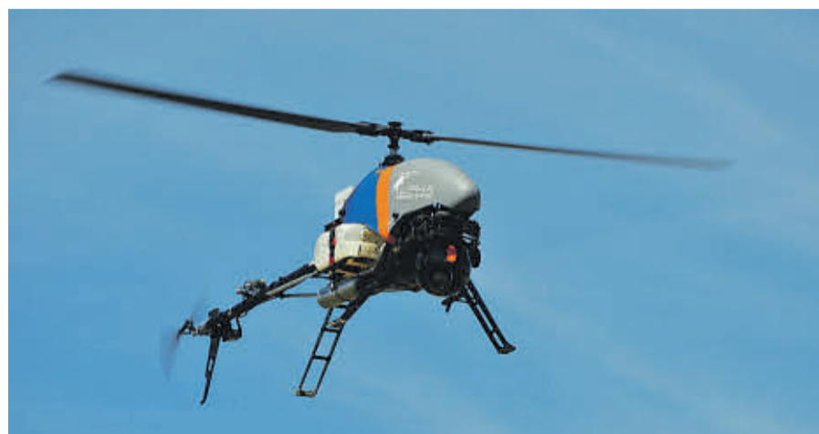
El helicóptero UAV Alpha 800, con una suspensión cardán para cámara Epsilon 140. eE
