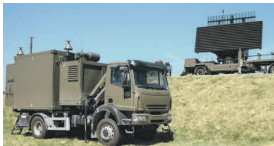
Sistema de Radar de aproximación para aeronaves civiles o militares. EE
