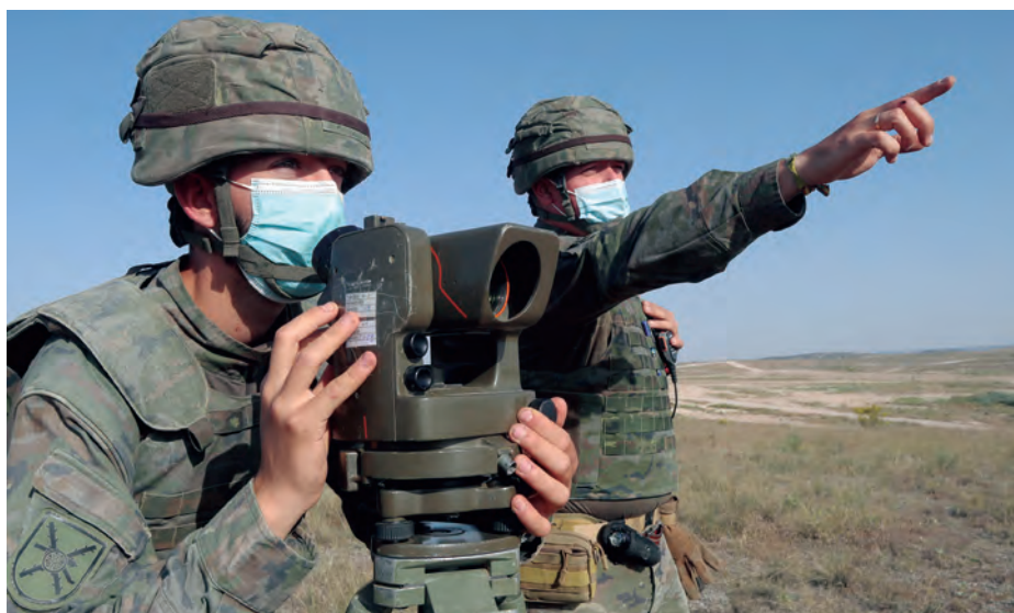
Miembros de la dotación de un obús autopropulsado realizan un levantamiento topográfico para situar sobre el terreno la pieza en las mejores condiciones de tiro.
