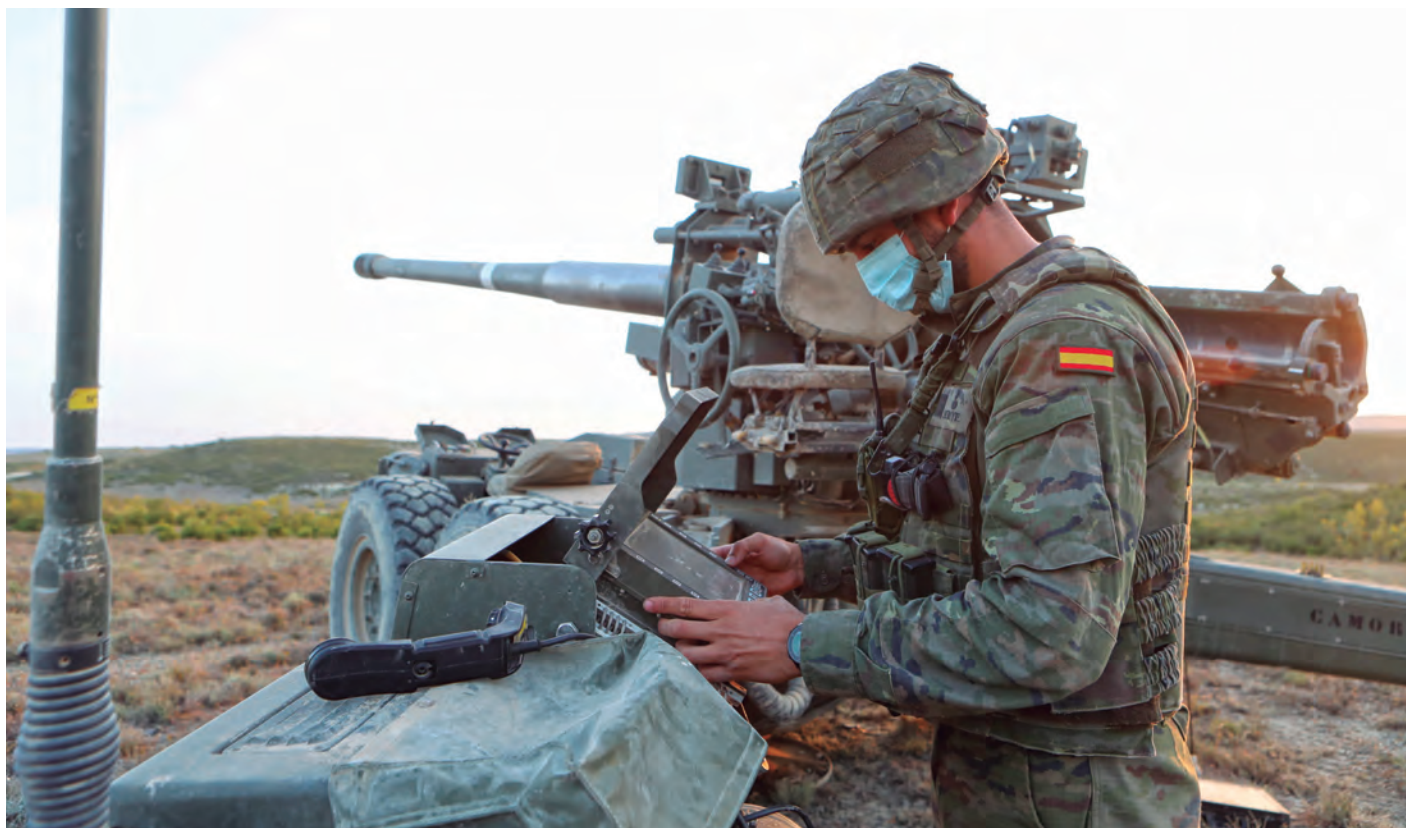
El jefe de pieza de un SIAC V07 introduce los datos de tiro antes de efectuar un disparo de señalamiento para fijar el objetivo.
